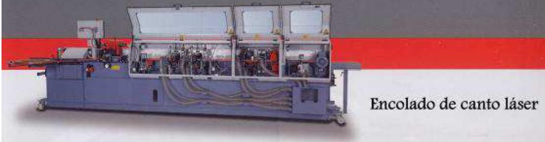
El sistema de encolado de “canto láser” AIRTRONIC funciona mediante la inyección de aire caliente a alta presión. Este aire caliente funde la película adherente que se encuentra en la parte interior del canto, permitiendo así su encolado de forma precisa y con una altísima calidad de fijación. El “canto láser” ofrece un acabado de alta calidad técnica y estética.
