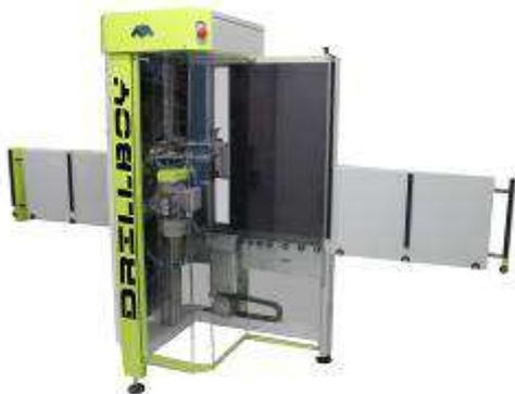
El cabezal cuenta con exclusivo dispositivo patentado para controlar y corregir la posición de los taladros respecto a la distancia tanto al borde derecho como izquierdo, permitiendo ensambles perfectos con sistemas de unión tipo minifix, rafx, etc., solucionando así los problemas de falsa escuadra y de diferencias en el largo de la pieza.
