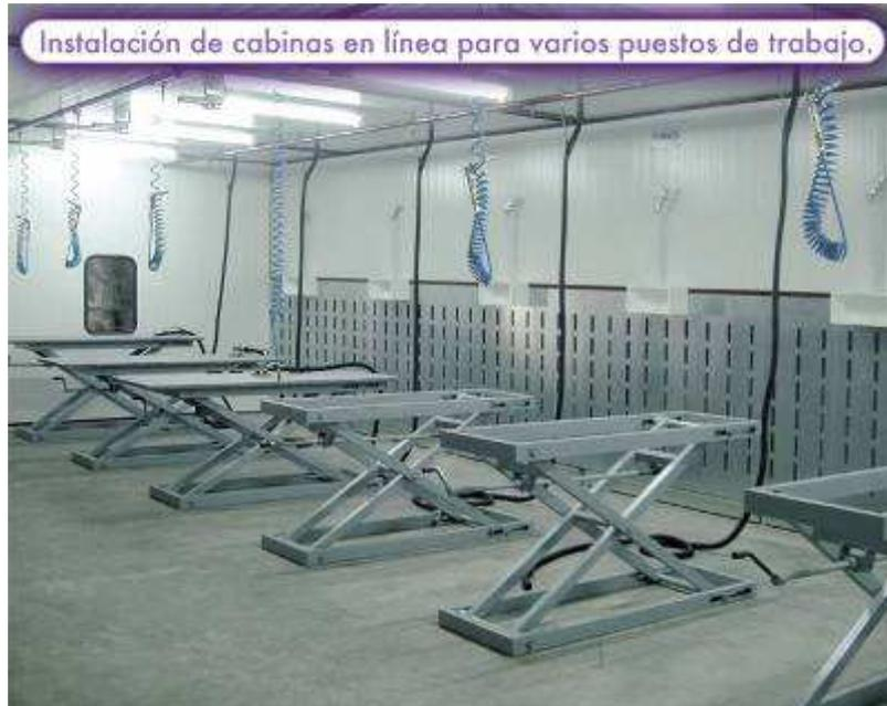
El aire aspirado por los ventiladores pasa a través del frontal perforado de la cabina hacia el interior de la cámara de depuración, donde se encuentran las mangas filtrantes.
